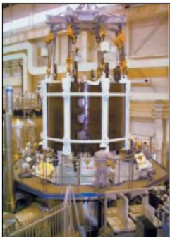
Атомы водорода вводятся в камеру ТОКАМАКА, предварительно приобретя энергию 1 МэВ в системе линейного ионизатора, ускорителя и нейтронизатора.
