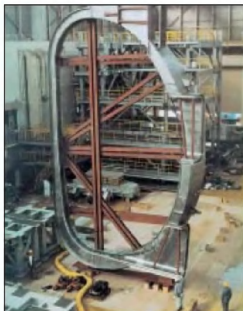
Секция вакуумной камеры в цехе завода-изготовителя. Размеры этой гигантской детали должны быть выдержаны с точностью до пяти миллиметров.
